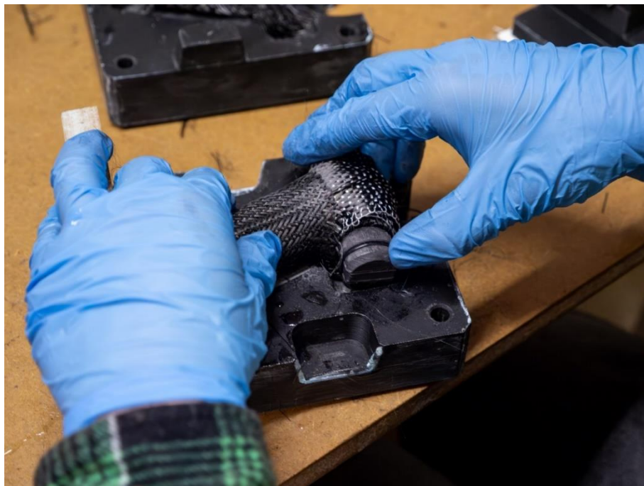
Laminowanie końcówek wahaczy metodą forged carbon fiber
