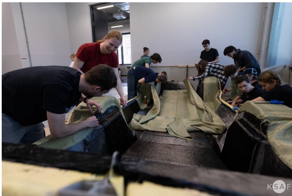
Układanie włókien węgiel-aramid – laminacja podwozia
