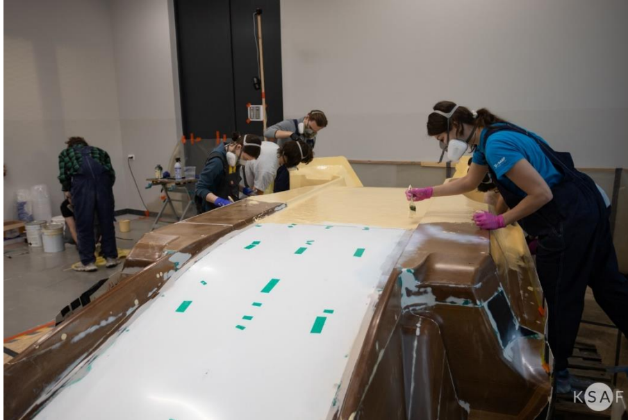
Proces nakładania żelkotu na kopyta z MDF - laminacja formy na podwozie
