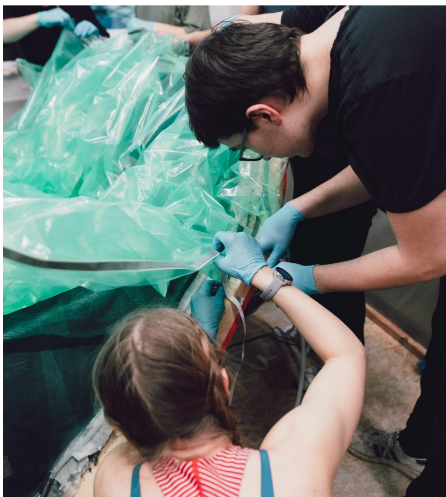
Proces przyklejania butylu z workiem próżniowym na formę
