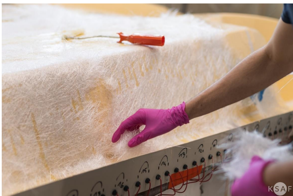
Laminacja formy podwozia metodą wet lay
