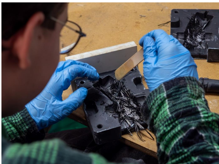
Laminowanie końcówki wahacza metodą Forge
